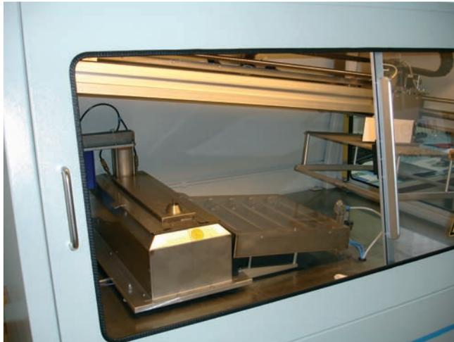
Blick in den Innenraum einer Selektivlötanlage von Ebso
